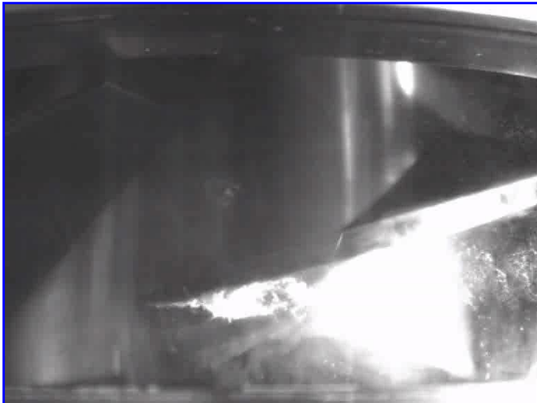
Q < Q_{\text{stoßfrei}} Teillastbetriebszustand
