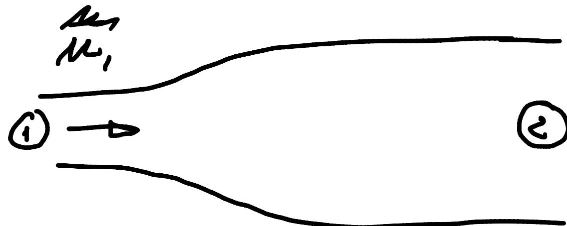
$\Delta P_v$  stößiges Druckverlust
