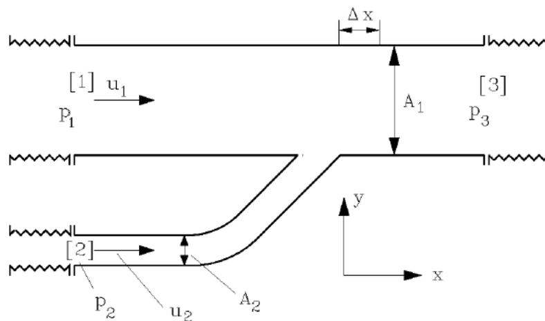
Abbildung 1: Durch Wellenrohre gehaltene Rohrverzweigung
