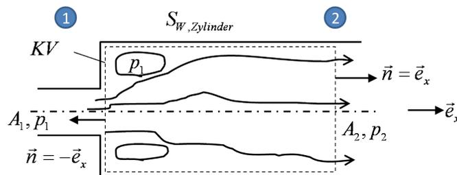
In Abbildung 1.1 ist ein sogenannter „ideal schlechter“ Diffusor abgebildet. Beim Durchströmen in die plötzliche Querschnittsaufweitung wird Energie dissipiert, man spricht vom „Carnotschen Stoßverlust“, der sich in einem Druckverlust  $\Delta p_v$  bemerkbar macht. Berechnen Sie diesen Druckverlust. Gehen Sie dafür in folgenden Einzelschritten vor:
