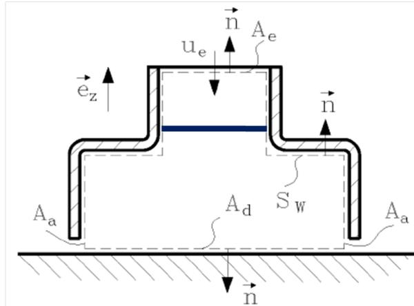
Abbildung 4: Kontrollvolumen am Luftkissenfahrzeug
