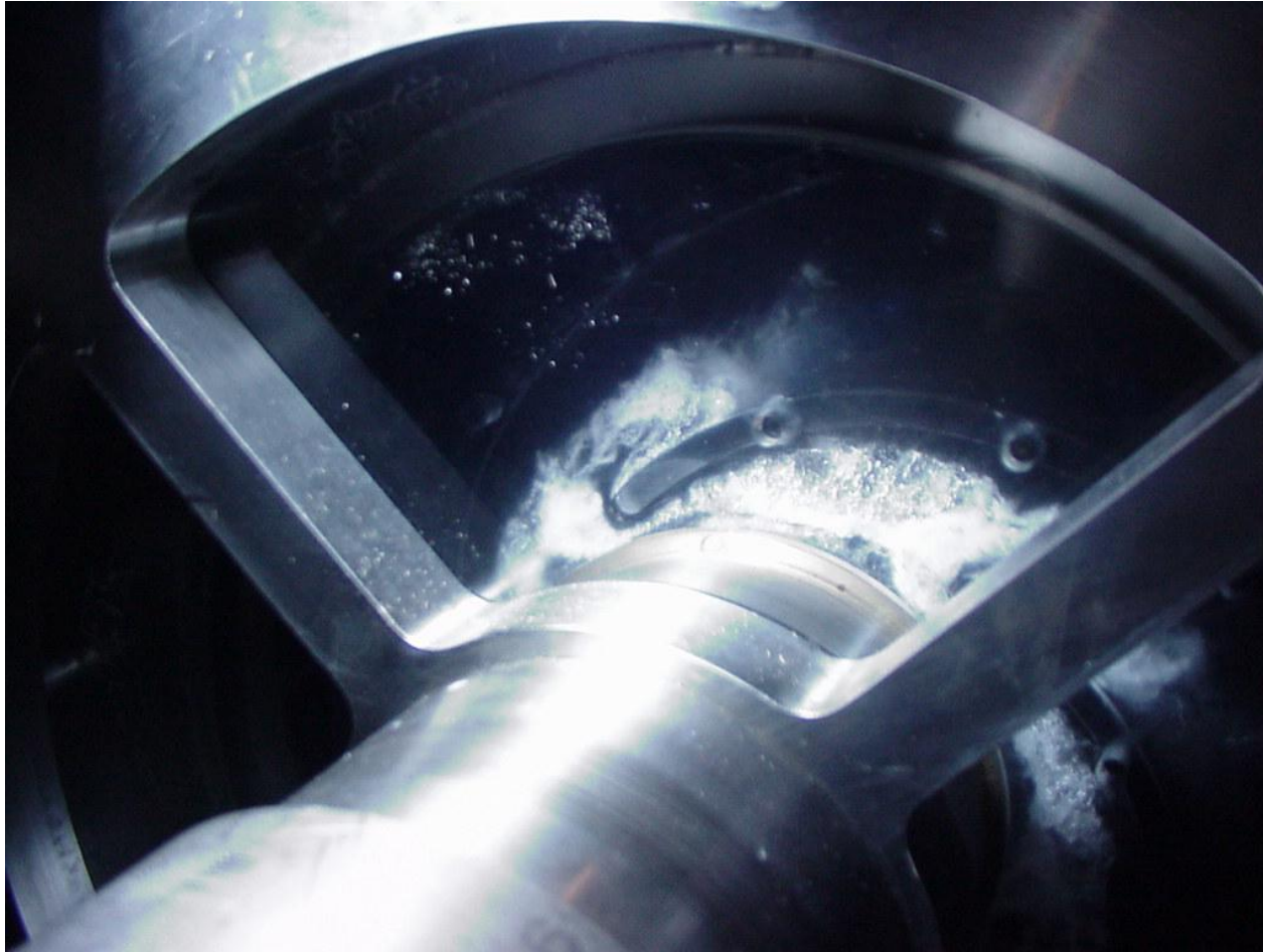
Kavitation in einem Pumpenlaufrad
