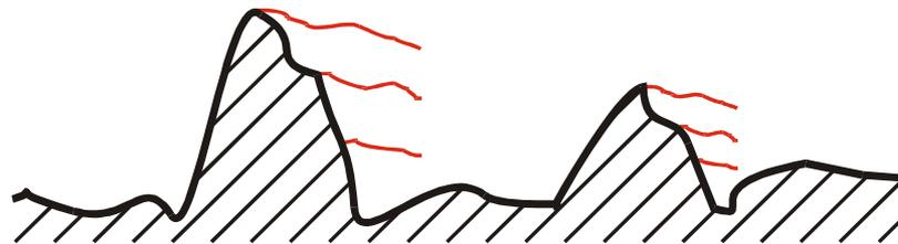
Zusätzliche Verwirbelung und Druckabsenkung hinter den Rauigkeitserhebungen.
