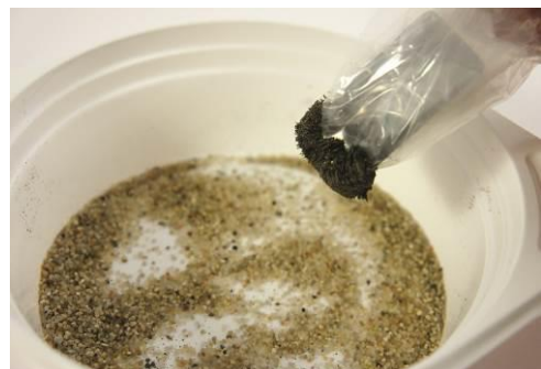
Arbeiten mit dem verpackten Magneten als „Eisensauger“.
