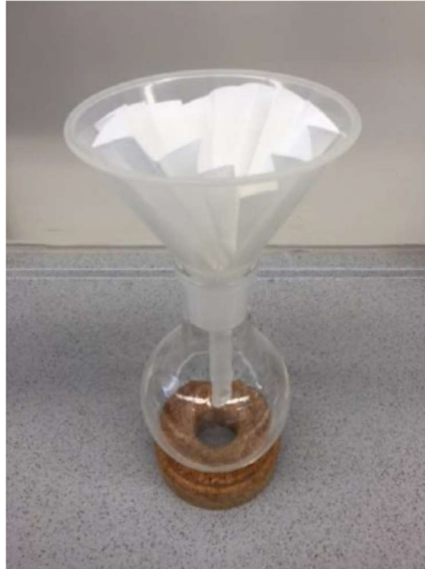
Abbildung 10: Filtration über Faltenfilter in einen abgewogenen Rundkolben
