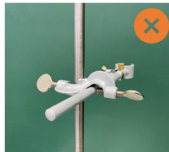
Stativ mit falsch montierter Muffe und Stativklammer
