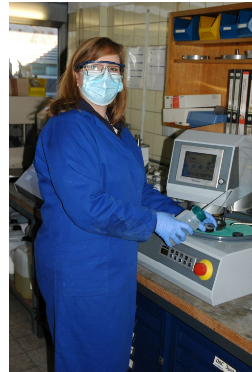
Präpariermaschine, hier wird geschliffen und poliert
