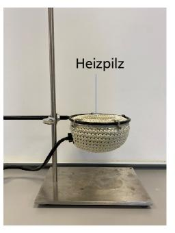
Mit der Muffe wird der Heizpilz so angebracht, dass eine Handbreit Platz darunter ist.
