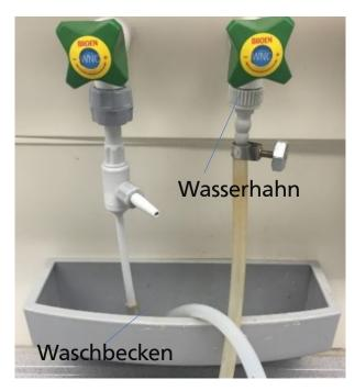
Der Schlauch für den Kühlwasserzulauf wird am Wasserhahn angebracht und auch mit einer Schlauchschelle gesichert. Der Schlauch für den Kühlwasserablauf wird ins Waschbecken gelegt (Muffe anbringen, damit der Schlauch schwerer ist).
