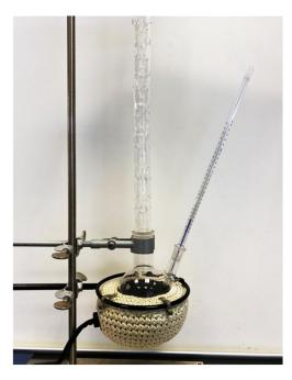
Dann schließt man die Öffnung mit dem zweiten Schliffthermometer.
