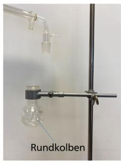
An diesem Stativ wird mit Muffe und Klammer ein Rundkolben (100 ml) angebracht.
