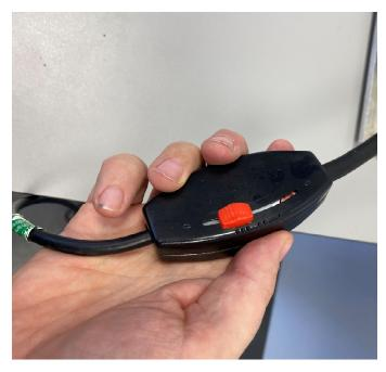
Jetzt kann der Schalter des Heizpilzes auf Stufe 3 gestellt und mit der Destillation begonnen werden.
