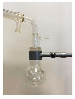
Nun sorgt man dafür, dass das Ende der Destillationsbrücke im Kolben steckt.
