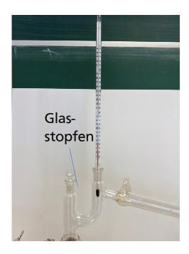
Das Thermometer wird in den rechten Schliff gesteckt. Der linke Schliff wird mit einem kleinen Glasstopfen verschlossen.
