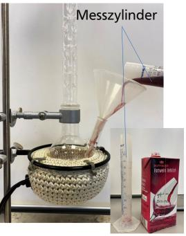
Anschließend werden mit dem Messzylinder 170 ml Rotwein in den Zweihalskolben gefüllt.
