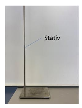
Die Stativstange wird in die Stativplatte geschraubt
