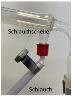
Auf die Schlaucholive schiebt man einen Schlauch mit Schlauchschelle, die man anschließend gut festdreht.
