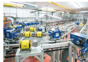
Der Elektronenstrahl durchläuft den Hauptbeschleuniger des S-DALINAC (hinten Mitte) mehrmals. Dabei bewegen sich die Teilchen auf drei Driftstrecken
