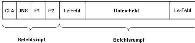
Abb. 4.1: Anordnung der Felder in einer CAPDU; Quelle: TU-Berlin
