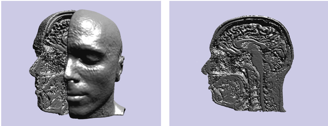
Abbildung 6.2: Einfaches Volumen-Clipping kann erreicht werden, indem Teile der Voxel auf Extremwerte gesetzt werden. Dies kann interaktiv über einen CUDA-Kernel geschehen. Die so durchtrennten Isoflächen werden automatisch geschlossen und die Kanten lokal abgerundet.
