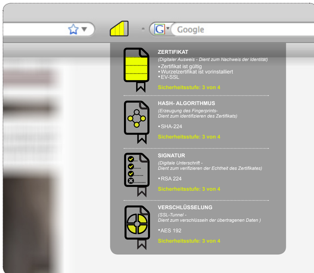
Abbildung 62: „Sec-Rank“ – Erweiterte Anzeige der Klassifizierung der Sicherheitsmerkmale
