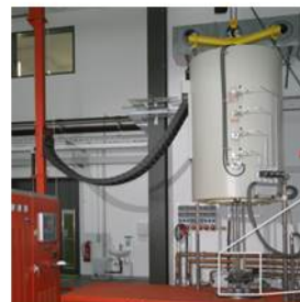
Borieranlage am Fraunhofer IST
