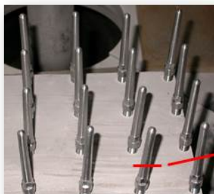
Pinolen für den Aluminiumdruckguss
