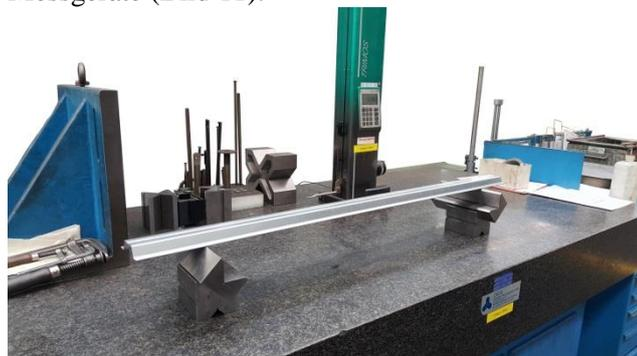
**Bild 11:** Taktiler Vermessung der Profilgeometrie
