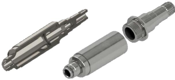
Bild 3.5: Fertigungskonzept für eine „gebaute“ Welle mit auf die Motorlänge anpassbaren Komponenten, Quelle: [24]
